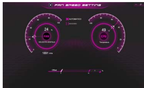
Figura 14 - Controllo della velocità del VENTOLA
